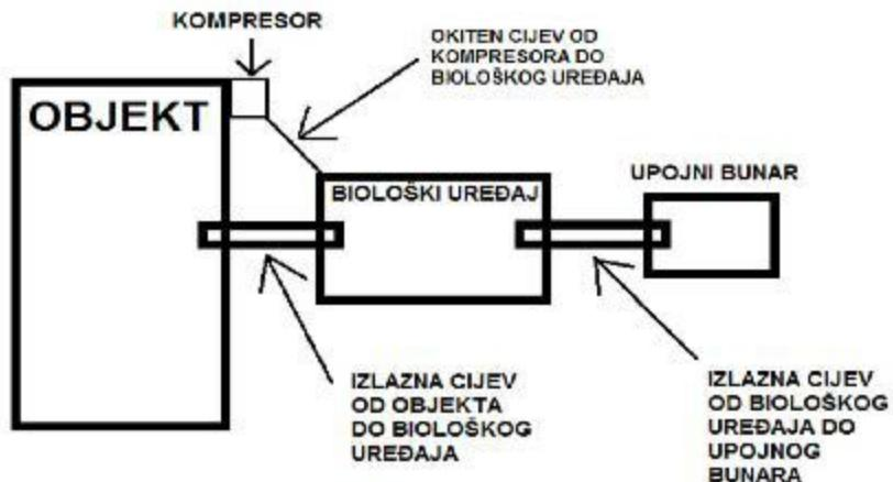
Slika uređaja sa svim dijelovima:
